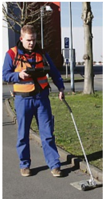
Robin Berner kontrolliert mit einem Gasspürgerät die Leitungen für die EAM. (Foto: privat)
